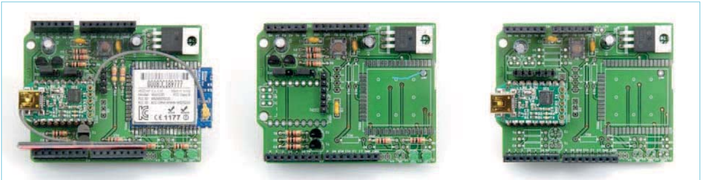
Bild 4. Die drei Hauptvarianten nebeneinander. Das Bluetooth-Modul beim mittleren Board ist nicht sichtbar, da es auf der Unterseite der Platine bestückt ist. Bei den Bildern handelt es sich um einen frühen Prototypen, dessen Platine der von Arduino Uno entspricht. Die endgültige Platine ist rechteckig.
