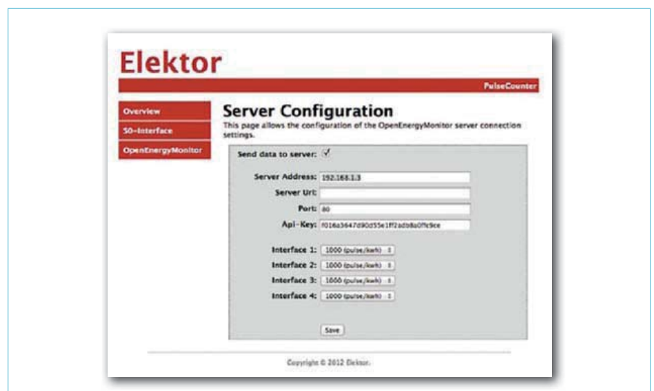
Bild 4. Konfiguration des OpenEnergyMonitor-Servers.
